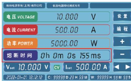
针对熔断测试, 增加熔断时间显示。
