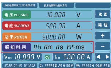
针对脱扣测试, 增加脱扣时间显示。
