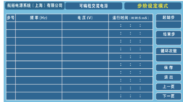
步阶设置页面可设置所需频率、电压、运行时间、初始步、结束步和循环次数
